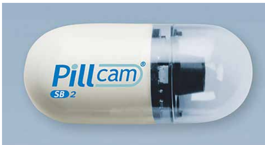
Given Imaging kapselkaamera mõõdud on 11x26 mm ja see kaalub vähem kui 4 grammi. Foto: www.givenimaging.com
